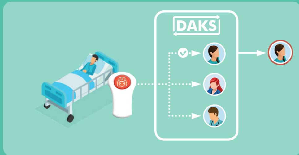
**DAKSeco** leitet den Lichtruf gezielt auf das Telefon der jeweils zuständigen Pflegekraft. Das reduziert die Gesamtzahl der Rufe für die einzelne Pflegekraft und es kommt zu weniger Unterbrechungen.
